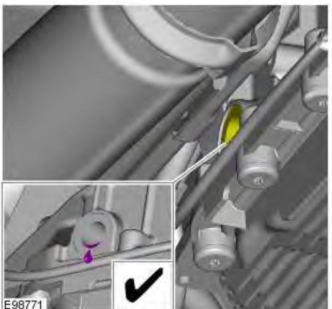
3. 使变速器油从变速器加油塞孔中排出，直至几乎停止。
